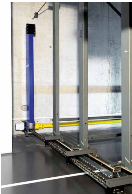
Chaîne de poussée avec guidage
