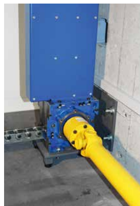
Entraînement du convoyeur par chaîne de poussée
