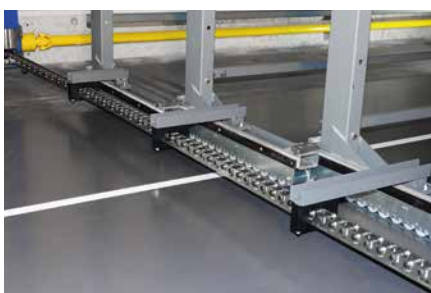
Chaîne de poussée avec guidage
